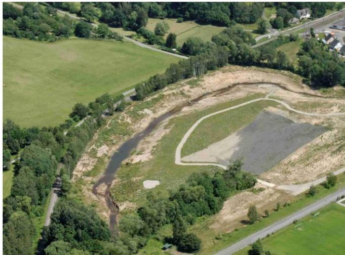
**Abbildung 3: Auf dem Gelände des ehemaligen Riffergeländes in Kaufungen wurde die zuvor in einem Betonkastengerinne kanalisierte Losse renaturiert und dabei ein Hochwasserretentionsraum von rund 67.000 m<sup>3</sup> Volumen geschaffen (Foto Bohnhardt/Gemeinde Kaufungen)**
